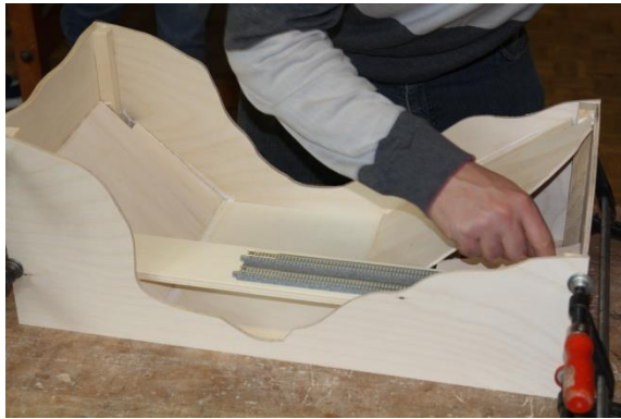
Bild 3: Der Modulrahmen wird zusammengeleimt.
